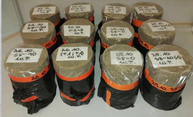
próbki cementogruntu oczekujące na badanie wytrzymałości na ściskanie
