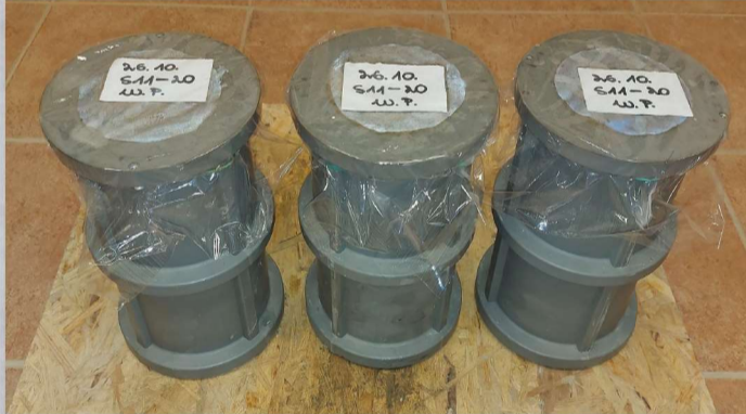
zaformowane próbki cementogruntu
