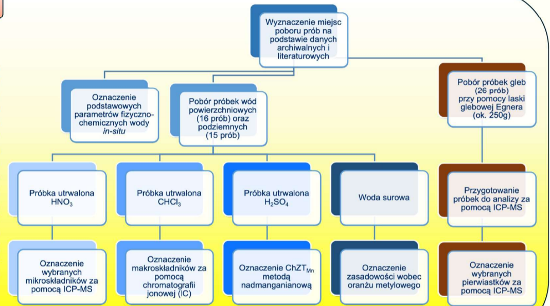
Ryc. 2. Schemat prac terenowych oraz laboratoryjnych
