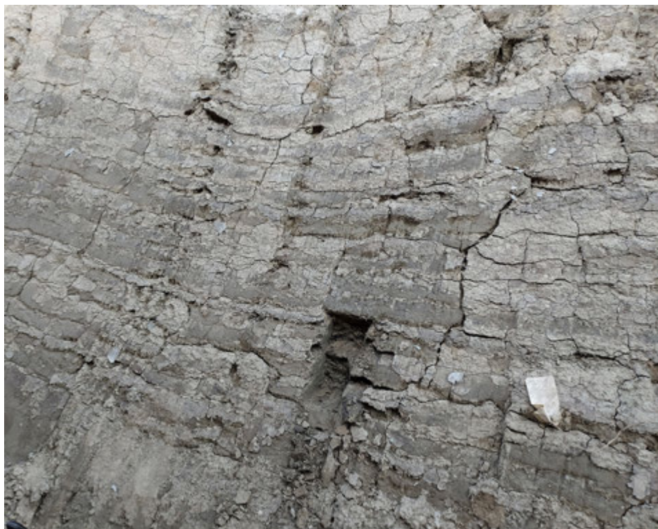
Ryc. 5. Sedymentacja rytmiczna ilów warwowych na obszarze budowy osiedla mieszkaniowego Stara Cegielnia (fot. D. Abramowicz)
