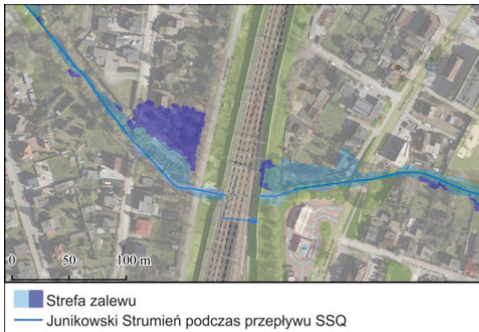
Ryc. 8. Wizualizacja modelowania hydrodynamicznego zasięgu wezbrania Junikowskiego Strumienia w sąsiedztwie ulic Armii Poznań i Dworcowej w Luboniu (kolor niebieski strefy zalewu wyznacza zasięg wezbrania o prawdopodobieństwie p = 5\% i p = 10\% , natomiast kolor fioletowy zasięg wezbrania o prawdopodobieństwie p = 20\% , czyli raz na 5 lat) (niebieska strzałka oznacza kierunek przepływu)
